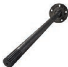
Ponta de Eixo Traseiro Lado Direito / Curto Comprimento: 695mm 19 Estrias Utiliza Rolamento 88128
