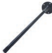
Ponta de Eixo Traseiro Comprimento: 755mm 22 Estrias
