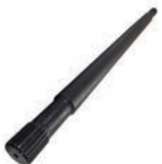
Semi Eixo Rodado Duplo 22 / 20 Estrias Lado Direito Comprimento: 980,00mm
